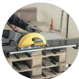
Ideal für Gitterroste mit LBS-Sägeblatt
