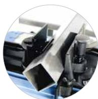
„K“ SPANNVORRICHTUNG FÜR VIERKANTROHRE
