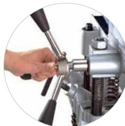
Bedienkreuz werkzeuglos auf beiden Seiten einsetzbar
