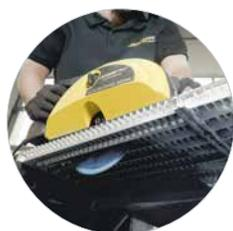
Ideal für Gitterroste mit LBS-Sägeblatt
