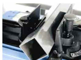
Système de serrage prismatique pour tubes carrés
