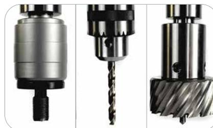
Taraudage, perçage et carottage
