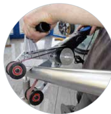
Perfect voor het afwerken van buizen, tot 270° contact met het werkstuk
