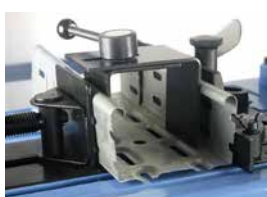
Thifix - klemsysteem voor open profielen
