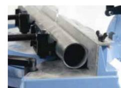
Système de fixation „K“ pour tube
