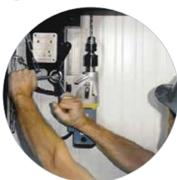
Optionele boorkop met Weldon 19 mm adapter voor spiraalboren
