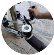
Polissage de tubes jusqu'à diamètre 70 mm
