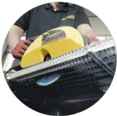
Ideal für Gitterroste mit LBS-Sägeblatt schockresistent
