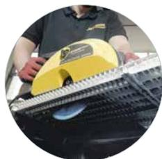
Ideal für Gitterroste mit LBS-Sägeblatt
