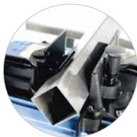
**„K“ SPANNVORRICHTUNG FÜR VIERKANTROHRE**
