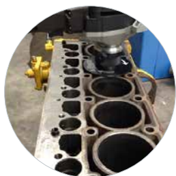
Ébavurage et chanfreinage polyvalent de contours, rayons et étroits trous, cordon de soudure 30° / 45° et préparation des bords visibles, etc.
