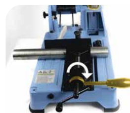
5. Tourner la poignée de dégagement rapide vers la droite et ensuite revenir aux étapes: 3 - 4 - 5.
