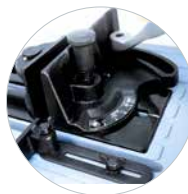
VERSTEKSNEDEN KUNNEN ZONDER GEREEDSCHAP WORDEN Aangepast van 90-75-60-45 °
