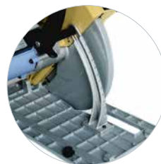
Diepteverstelling met schaalverdeling
