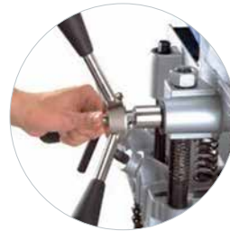
Bedienkreuz werkzeuglos auf beiden Seiten einsetzbar
