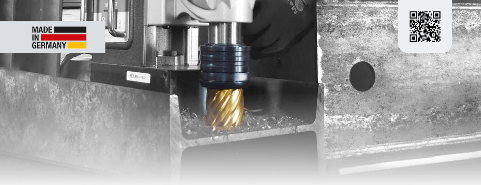
**TiN** signifie une grande résistance à l'abrasion, permet l'usinage de métaux durs, tels que les aciers inox par opposition à la fraise HSS-Co, surtout utilisée pour les aciers doux. L'usure de l'outil par frottement est considérablement réduite.
