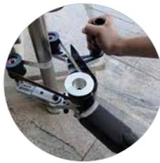
Polissage de tubes jusqu'à diamètre 70 mm
