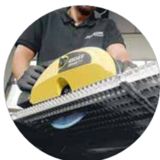
Ideal zum Sägen von Blechen, Gittern und Sandwichplatten bis 67 mm
