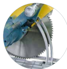
Tiefeneinstellung mit Skalierung
