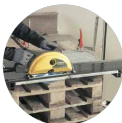
Ideal für Gitterroste mit LBS-Sägeblatt
