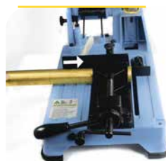
4. Das nächste Werkstück wird in die zu sägende Position gebracht.
