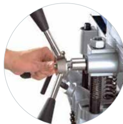
Bedienkreuz werkzeuglos auf beiden Seiten einsetzbar
