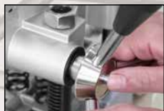
Bedieningshendel zonder gereedschap links en rechts te gebruiken
