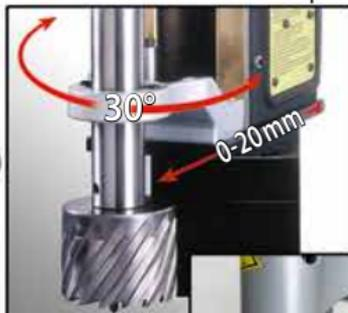
\* Base magnétique pivotante permet un positionnement précis vers la droite et vers la gauche de 15° et de 20 mm vers l'avant ou vers l'arrière.
