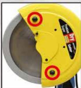
2 Vibrationsdämpfer (patentiert)
