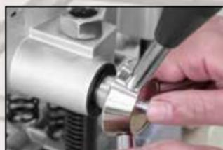
Bedienkreuz werkzeuglos auf beiden Seiten einsetzbar
