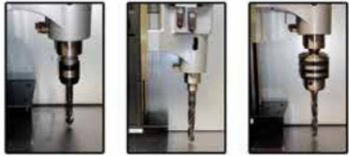
Gewindeschneiden und Vollbohren mit MK3-Adapter und Bohrfutter 16 mm mit Adapter
