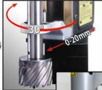
\*Variante Swivel Base erlaubt eine präzise Positionierung der Kern-, Gewinde- und Vollbohrer mit 15° rechts/links Schwenk sowie 20 mm vorwärts.
